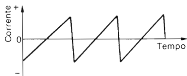
Fig. 5.15 - Andamento delle correnti che circolano nelle bobine per la scansione di campo e di linea.
