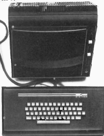
NBZ80-HL. Con 16K byte di RAM, tastiera alfanumerica con interfaccia video, 8K ROM di Basic su scheda addizionale, libro Basic Programming Primer, monitor TV (opzionale).
