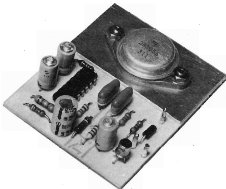
Vista in primo piano della sirena e la disposizione componenti sulla basetta.
